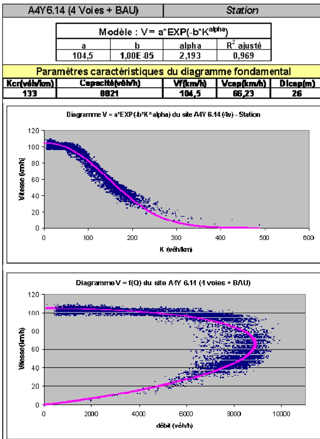
**Figure 43 : Calibrage chaussée (station), sens Paris-Provence, avant aménagement**
