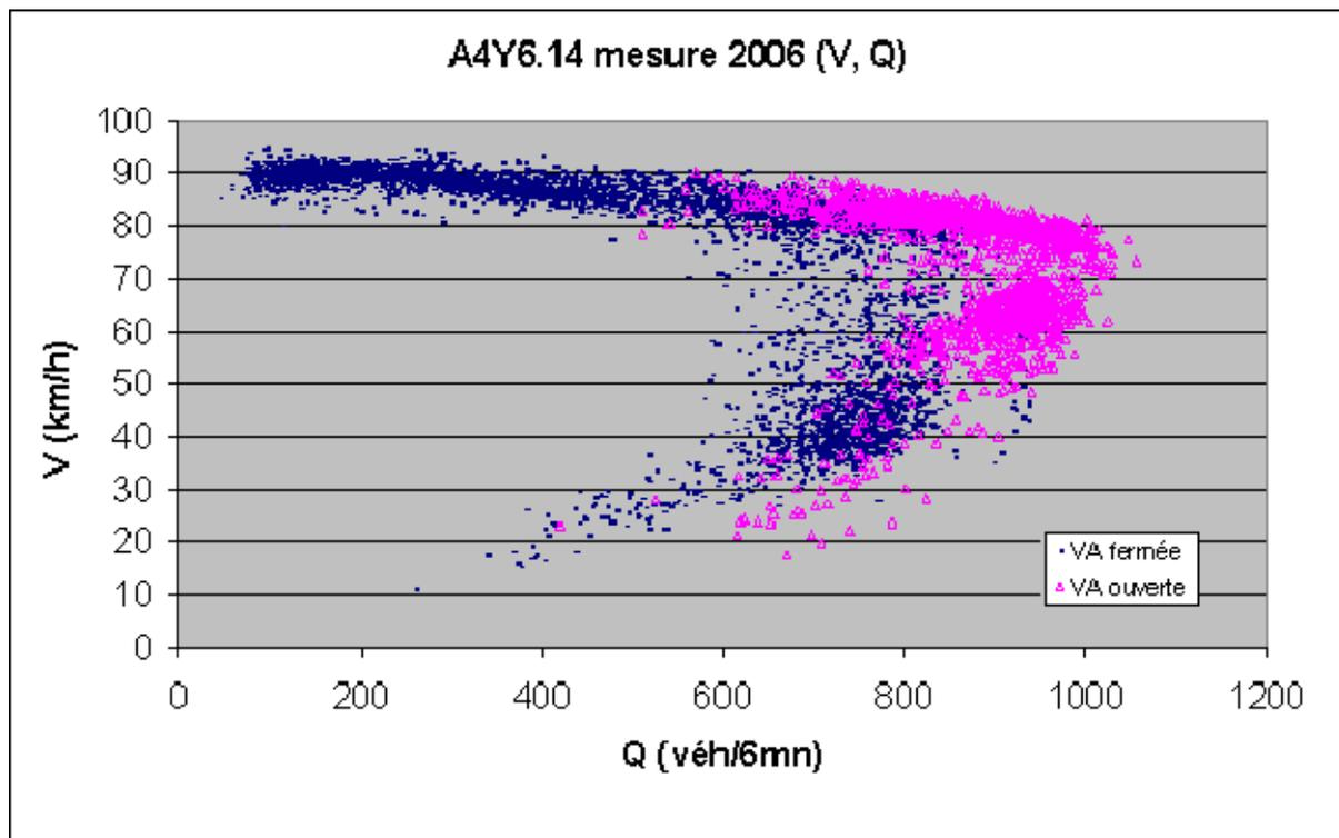
**Figure 40 : Nuage de points (Q, TO) et (V, Q) de la station A4Y6.14 des jours sélectionnés en 2006**
