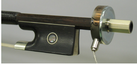
FIG. 6: Capteur de force monté sur l’archet.
