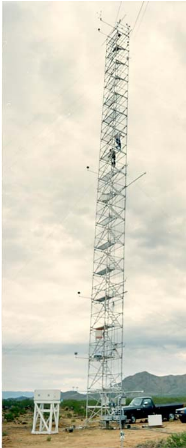
Figure 5 : Mât instrumenté de 32 m (photographie WSMR / expérience OTAN RSG-11)
