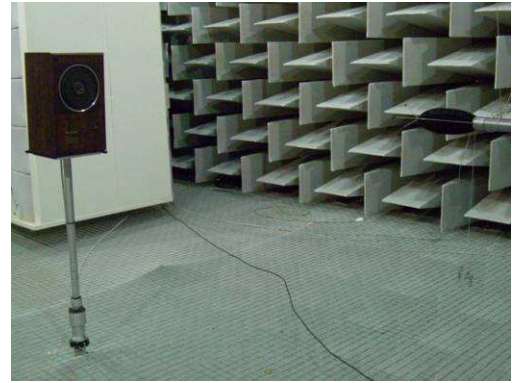
Figure 3 : salle anéchoïque du LNE ; procédure de vérification des sonomètres
