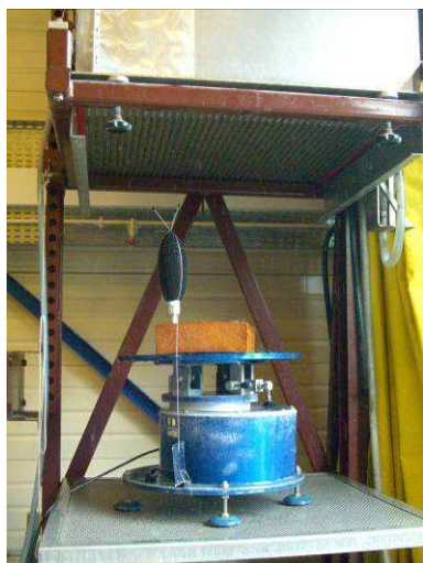
Figure 2 : Protection anti-pluie sous le système de génération de pluie artificielle normalisé du LNE
