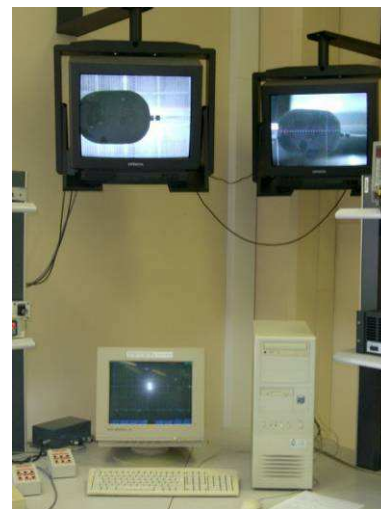
Figure 4 : Laboratoire du LNE ; positionnement du microphone par contrôle vidéo
