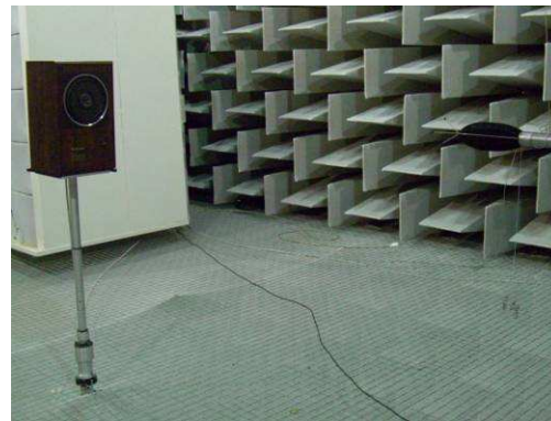
Figure 3 : salle anéchoïque du LNE ; procédure de vérification des sonomètres
