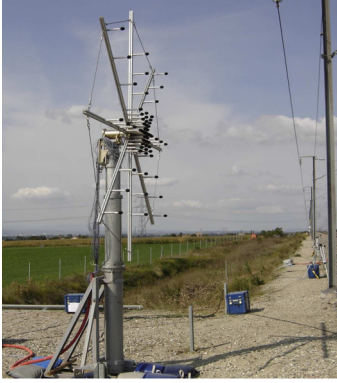
FIG. 1: Exemple d'antenne composée de deux étoiles encastrées.
