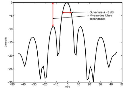
FIG. 3: L'ouverture du lobe principal et le niveau des lobes secondaires sont des indicateurs de qualité du filtrage spatial.
