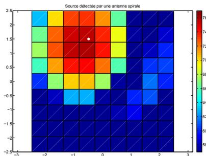
FIG. 18: Détection d'une source, située au point blanc, par l'antenne en spirale.
