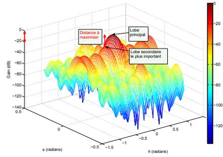
FIG. 5: Évaluation de l'influence des lobes secondaires en mesurant la différence en décibels entre le niveau du lobe principal et celui du lobe secondaire le plus important (*m<sub>sl</sub>*).
