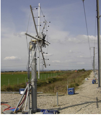
FIG. 1: Exemple d'antenne composée de deux étoiles encastrées.
