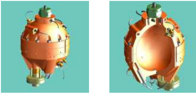
FIGURE 1 – Cavité quasi sphérique en cuivre utilisée pour la détermination de la constante de Boltzmann, vue extérieure et coupe.
