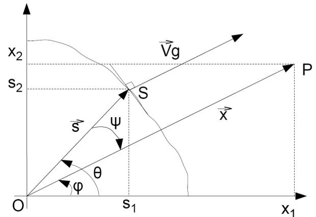
Figure 4: Le vecteur vitesse de groupe  $V_g$  au point d'observation P est normal la surface des lenteurs  $s(\theta)$ .
