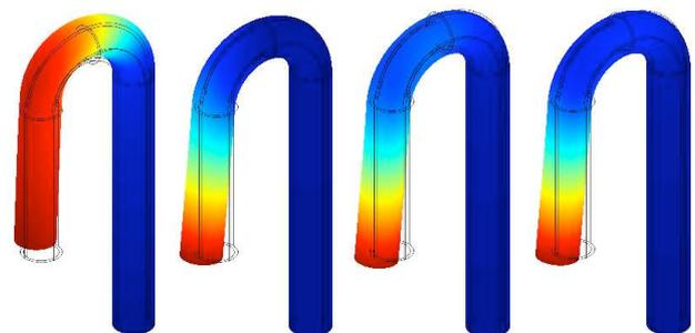
FIGURE 18 – Condition en accélération. Déformées à  $t = 0.1, 0.2, 0.3, 0.8$  (s)
