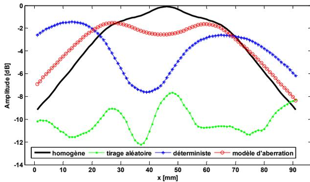
Figure 11: Amplitude maximale en dB le long d'un segment horizontal à 1,2m de profondeur
