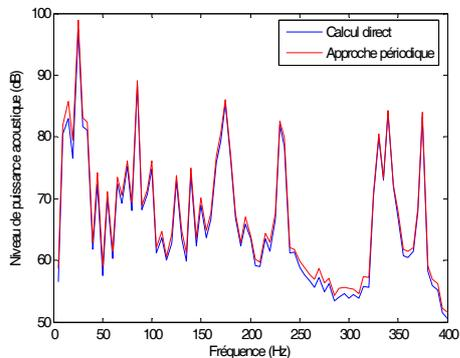
Figure 7 : Comparaison des niveaux de puissance acoustique.
