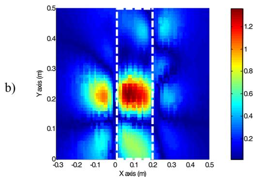
Figure 6 : Comparaison des champs de pression à 175 Hz ;
