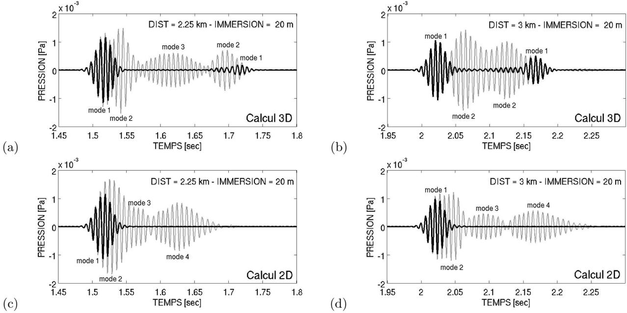
FIG. 4: Signaux reçus (courbes en gris) en travers de la pente à l'immersion  $z = 20$  m aux distances  $r = 2.25$  km (à gauche) et  $r = 3$  km (à droite) correspondant à un calcul 3D (sous-figures (a) et (b)) et un simple calcul 2D (sous-figures (c) et (d)). Les arrivées associées au mode 1 obtenues après filtrage sont tracées en noir.
