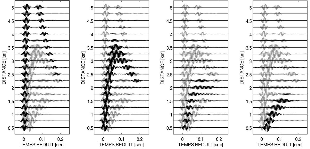
FIG. 3: De gauche à droite (courbes en noir) : évolution des signaux associés aux modes 1, 2, 3 et 4 en fonction de la distance source/récepteur (en travers de la pente, immersion : 20 m). Pour chaque distance, les signaux complets, avant filtrage, sont représentés en gris sur chacune des sous-figures.
