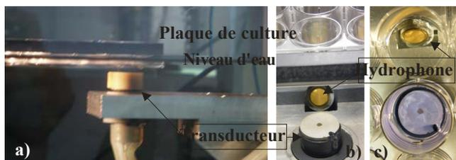
Figure 1 : dispositif expérimental ; a) Dispositif d'irradiation ultrasonore positionné sous la plaque de culture utilisant l'eau comme couplant ; b) Vue latérale et c) vue supérieure du dispositif.
