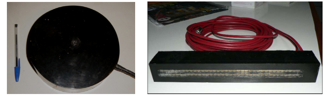
Figure 2 : Antennes circulaire (Ø 18 cm) et rectangulaire (26cm x 1.6cm).
