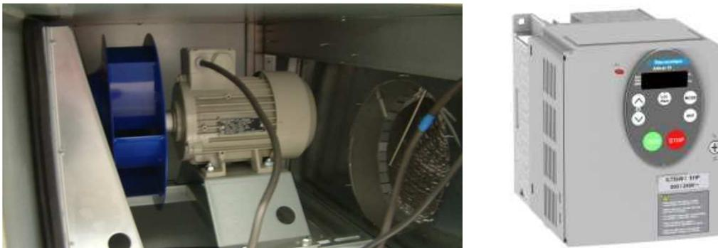
Figure 2 : Moteur et ventilateur utilisé dans la plate-forme PREDIS
