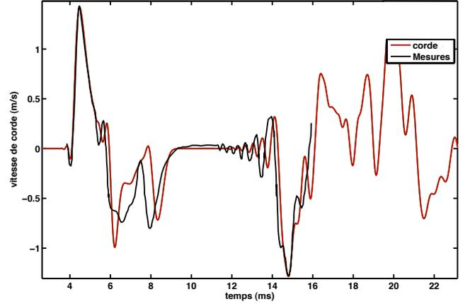
FIGURE 8 – Comparaison des vitesses d'un point observé (noir) et simulé (rouge), en fonction du temps.
