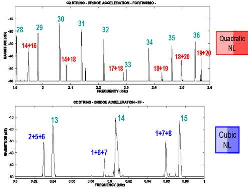
FIGURE 7 – Spectre de l'accélération au chevalet - corde C2 - frappe fortissimo. Agrandissement de deux zones spectrales montrant les non-linéarités quadratiques et cubiques.
