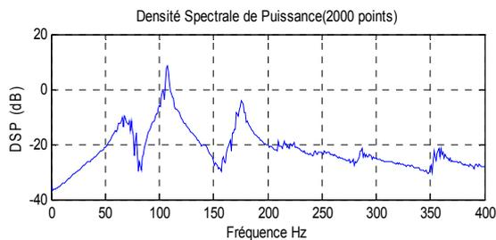
Figure 7 : Réponse fréquentielle du caisson acoustique par transformée de Fourier sur 2000 points
