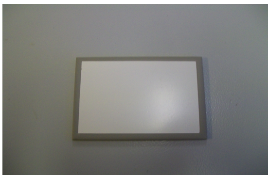
Figure 3: Deuxième échantillon : revêtement de peinture sur dural
