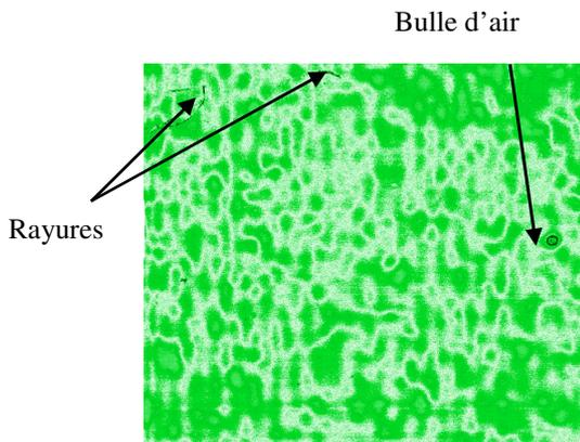
Figure 7 : Echantillon 2 : interface peinture – substrat (5mm par 5 mm)
