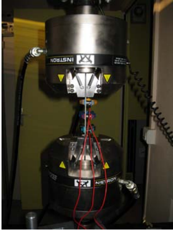
Figure 1 : Essai de traction instrumenté en capteurs d'émission acoustique.
