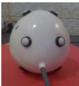
Figure 1 : Photographie de la « noix de coco », dispositif ovoïde à 8 boutons, chaque bouton désignant un haut-parleur.
