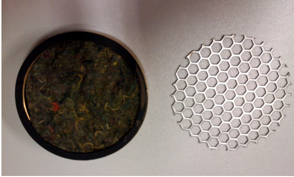
FIGURE 4 – Gauche : Couche de poreux dans son porte échantillon. Droite : grille limitant les vibrations du squelette du poreux.
