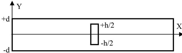
Figure 2 : La plaque d'acier considérée : avec défaut interne rectangulaire et symétrique.
