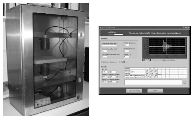
Figure 6 : Banc ultrasons du CTTM et logiciel Labview
