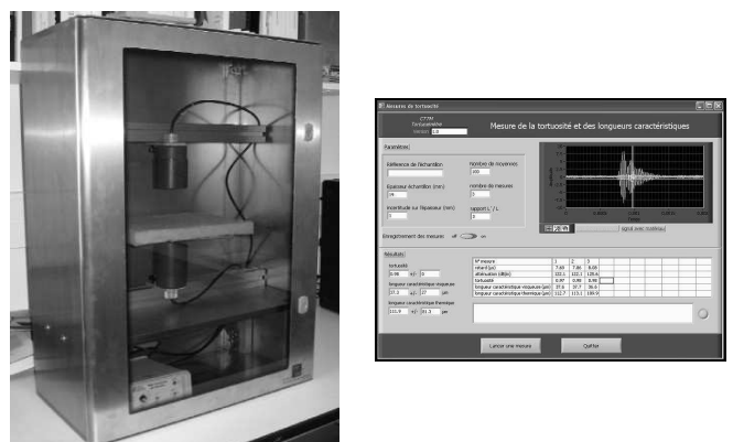
Figure 6 : Banc ultrasons du CTTM et logiciel Labview
