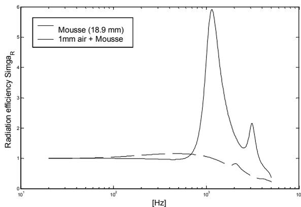
Figure 12 : Facteur de rayonnement d'une paroi couverte d'une couche poreuse avec et sans lame d'air intermédiaire.
