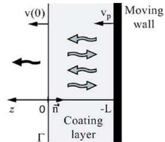
Figure 10 : Couche poreuse couplée à une paroi mobile [6].
