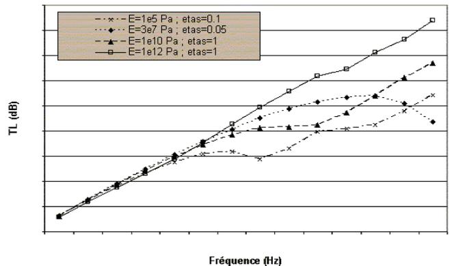
Figure 6 : Isolation en fonction de la fréquence pour plusieurs couches amortissantes de module d'Young et de facteur d'amortissement différents, appliquée sur une paroi simple.
