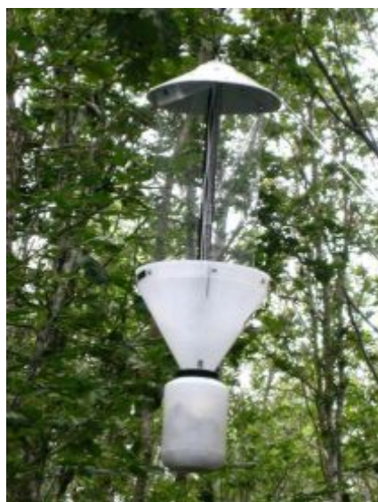
Photo 9 : Piège lumineux à déclenchement automatique utilisé en étude comparative des communautés de Lépidoptères nocturnes (Bonneil, 2005).
