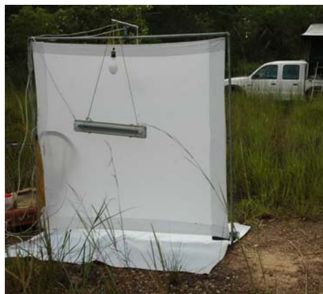
Photo 16 : Piège lumineux combinant ampoule à vapeur de mercure et néon noir (Zambie).
