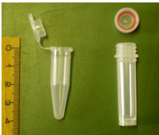
Photo 28 : Exemples de tubes pour le reconditionnement (à gauche : tube Eppendorf, référence Bioblock B51633 ; à droite : tube Micrew à bouchon vissant avec joint, références Bioblock B14437 et B14457).
