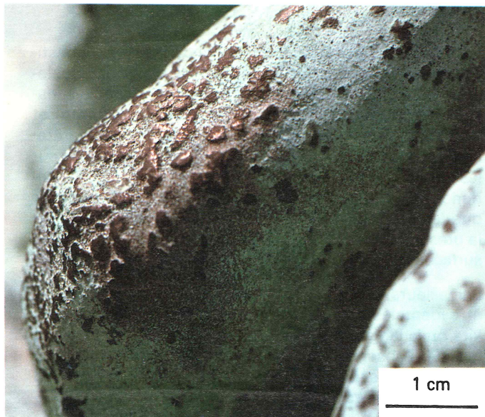
Figure 1a. — Aspect des altérations de surface. Zones noires sous forme d'îlots entourées de dépôts vert clair poreux et non protecteurs. A noter que les surfaces noires correspondent à la surface originelle de l'œuvre. Détail d'un doigt de la main d'Ugolin, Musée Rodin, Paris.
