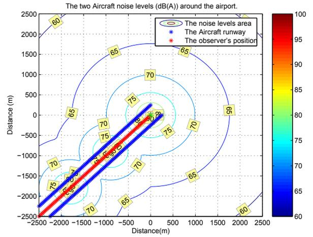
FIG. 3: Le bruit émis par les deux avions atterrissant simultanément.
