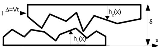
FIGURE 1 – Glissement de deux profils rugueux. Les altitudes  $h_i$  sont comptées de manière opposée. L'écart entre les deux profils est  $\delta$ . À l'instant  $t$ , le décalage horizontal est imposé  $\Delta = Vt$ .
