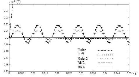
FIGURE 3 – Énergie totale d'un système simplifié sans force ni amortissement avec  $\tau = 10^{-6}s$  durée 0,05s
