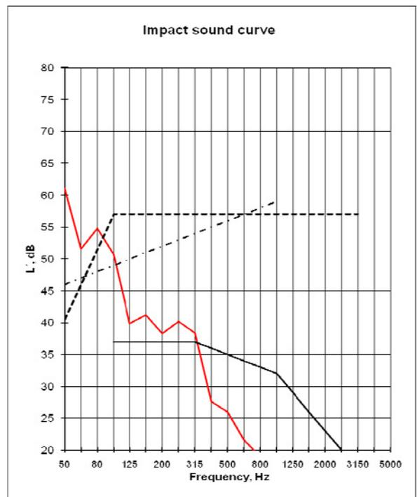
Figure 1(a) : Exemple de mesure réelle : Structure en bois, répondant aux normes de classe "A", mais objet de plaintes de la part des habitants.
