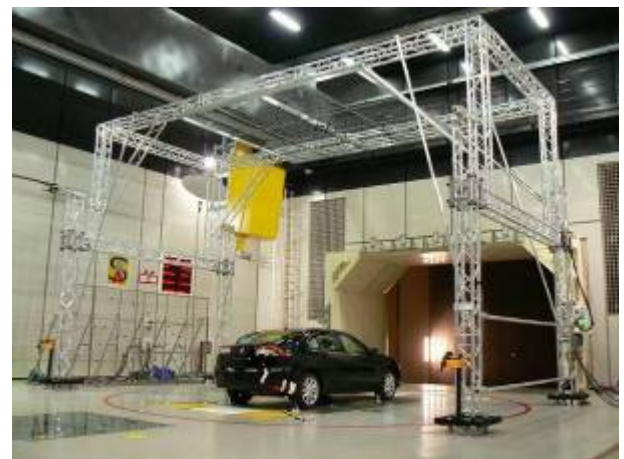
Figure 4 : antennes acoustiques latérale et verticale dans la soufflerie S2A
