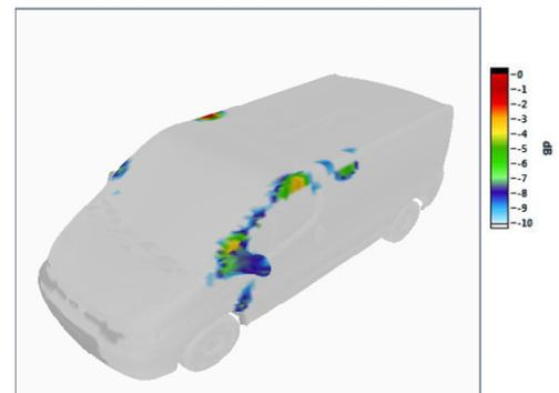
Figure 8 : cartographie intérieure 3D à 1000 Hz avec les deux antennes pour la place conducteur
