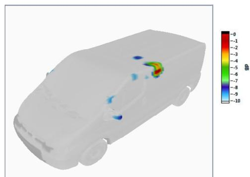
Figure 9 : cartographie intérieure 3D à 1000 Hz avec les deux antennes pour la place passager
