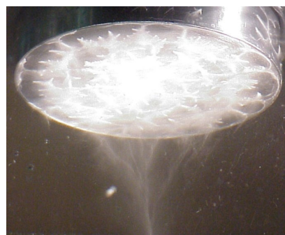
Figure 1 : structuration du champ de bulles de cavitation au voisinage d'une sonotrode à forte intensité
