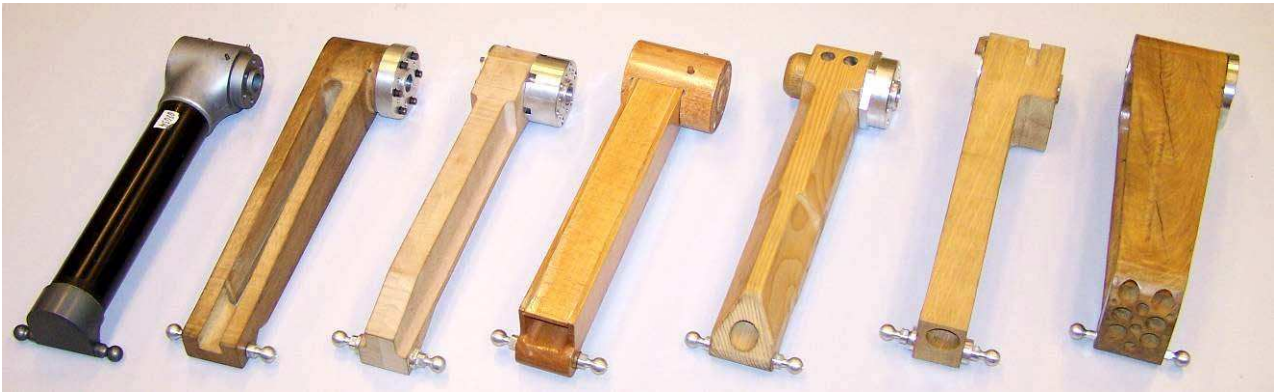
Figure 15. Photo du bras initial et de tous les prototypes réalisés (de gauche à droite) en carbone, chêne, hêtre, hêtre, pin, chêne, chêne.
