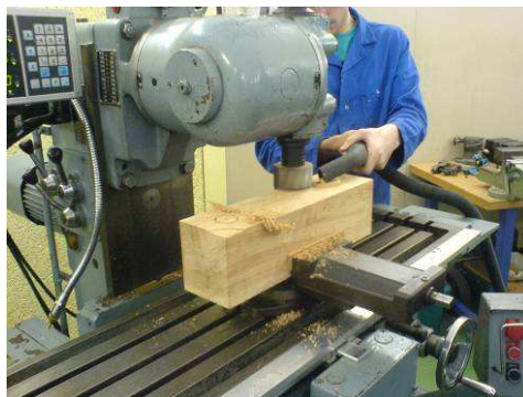
Figure 14. Fabrication du prototype sur machine conventionnelle.
