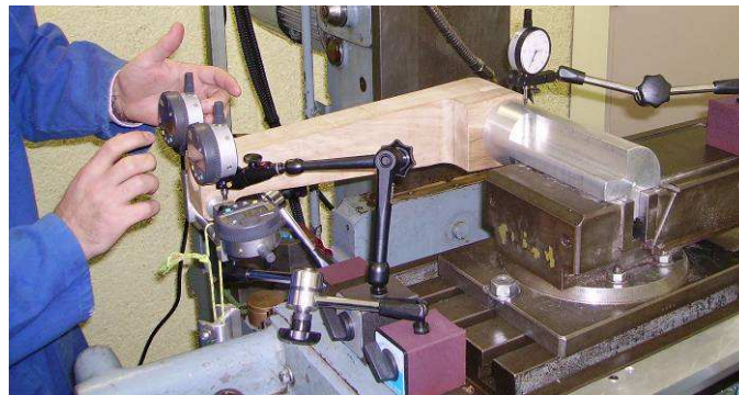
Figure 16. Test de raideur en flexion du prototype avec le même protocole que le bras en carbone.
