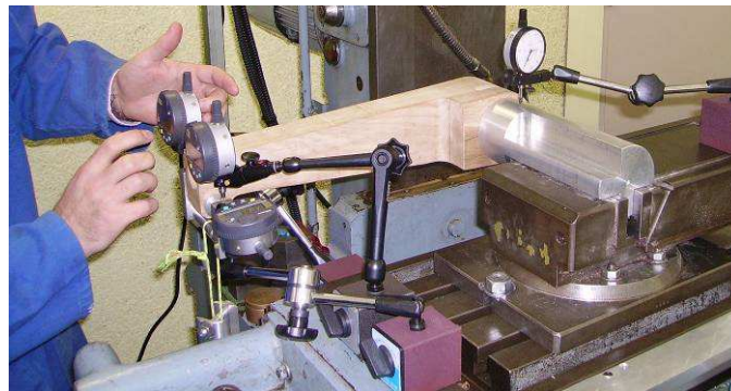
Figure 16. Test de raideur en flexion du prototype avec le même protocole que le bras en carbone.
