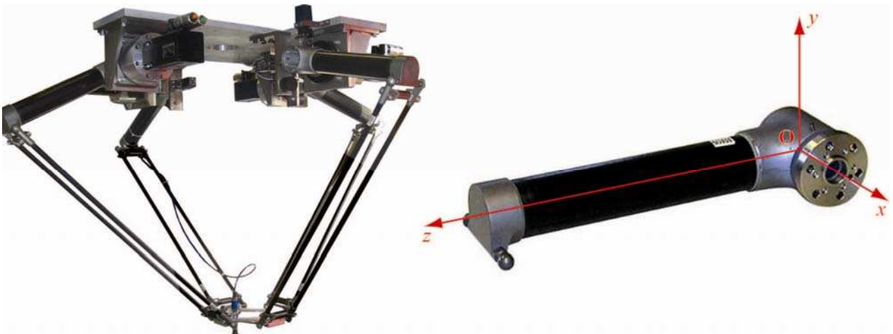
Figure 1. Le robot PAR4 et un bras d'origine (d'après documents LIRMM).
