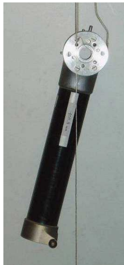
Figure 9. Exemple d'une photo prise pour déterminer la position du centre de gravité dans le plan (y, z). Une autre photo est prise en suspendant le bras par les rotules.
