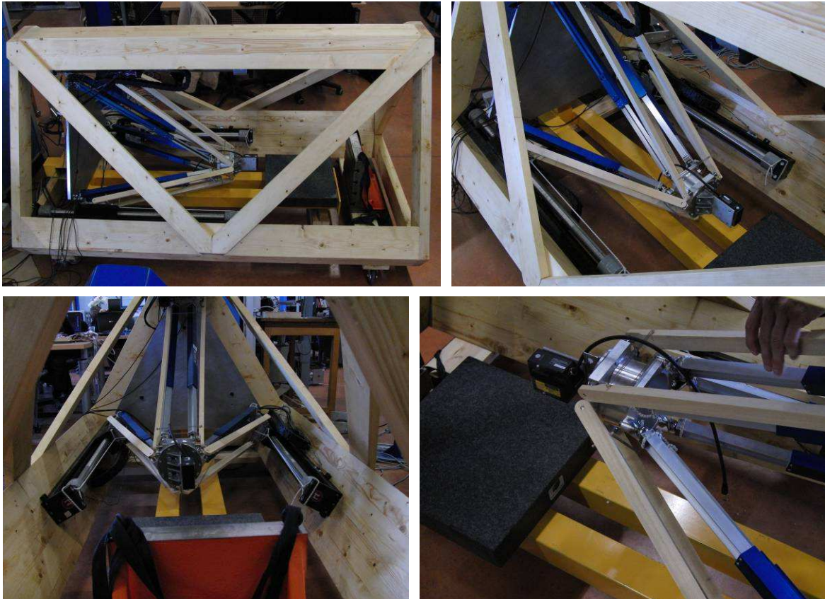
Figure 9. Photos de la Machine à Mesurer Tridimensionnelle (MMT) parallèle en bois, à actionnement et mesures dissociés, réalisée dans le cadre du PEPS Robois [17].
