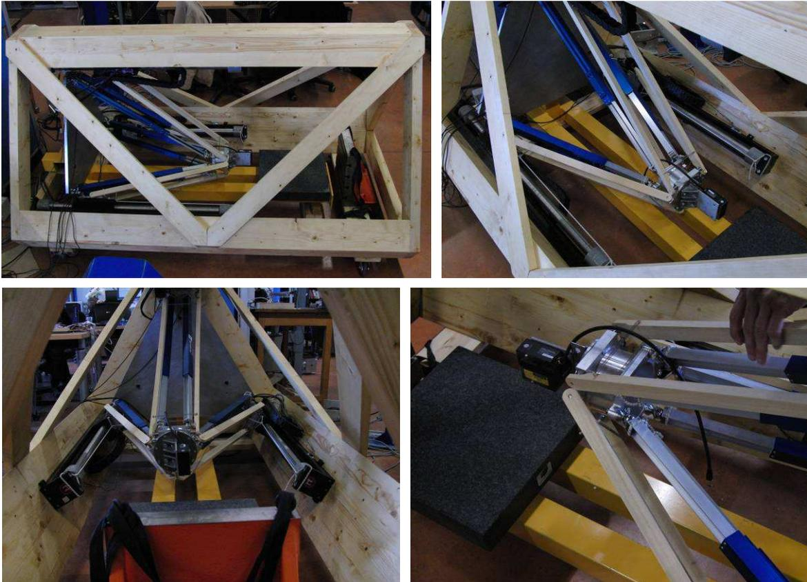
Figure 9. Photos de la Machine à Mesurer Tridimensionnelle (MMT) parallèle en bois, à actionnement et mesures dissociés, réalisée dans le cadre du PEPS Robois [17].
