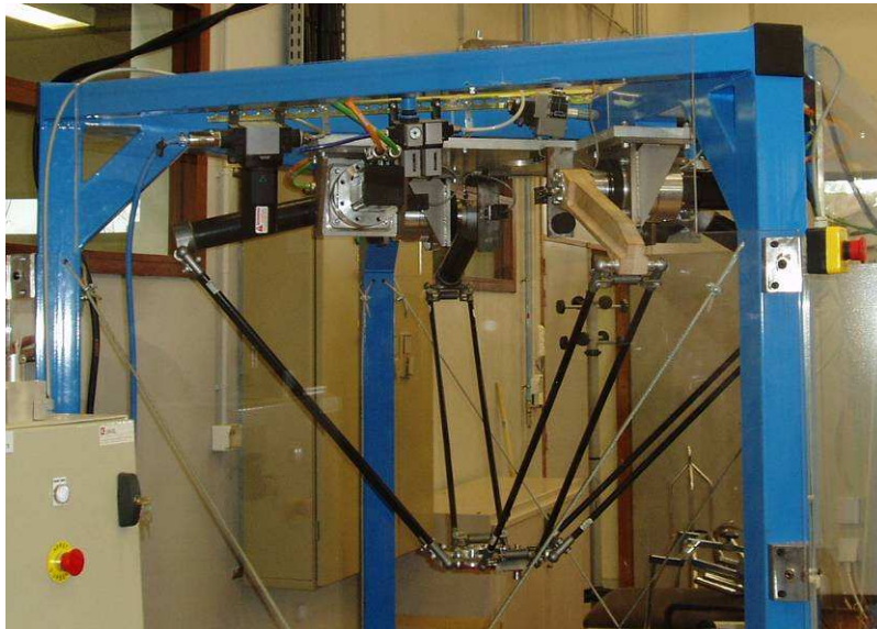
Figure 7. Test final de validation des bras avec pilotage des accélérations jusqu'à 17 g.
