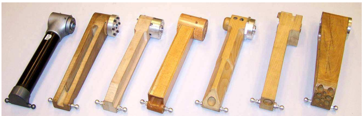
Figure 6. Photo du bras initial et de tous les prototypes réalisés ; de gauche à droite en carbone, hêtre, hêtre, pin, chêne, chêne.
