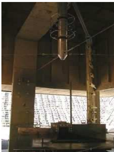
Figure 9 : Essais VEGA dans le banc Martel
