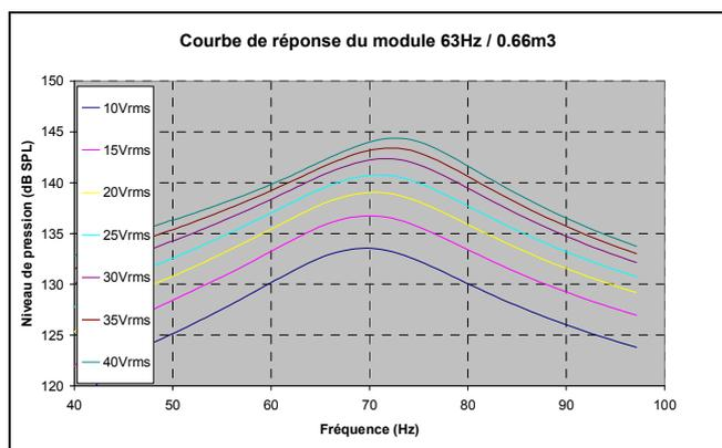
Figure 9 : courbe de réponse de l'actuateur 63Hz chargé par un volume clos de 0.66m<sup>3</sup>
