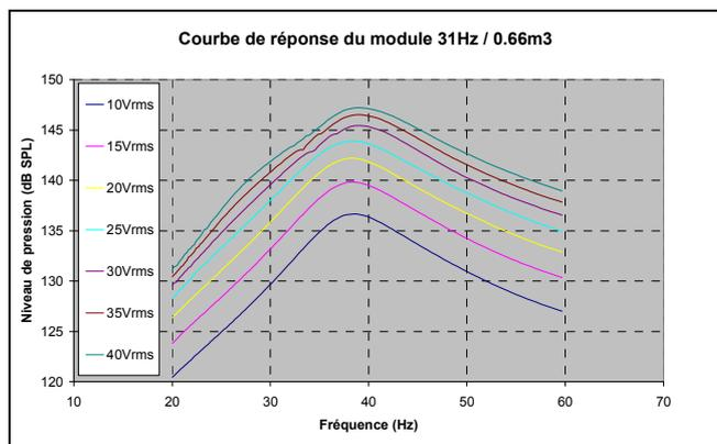
Figure 8 : courbe de réponse de l'actuateur 31.5Hz chargé par un volume clos de 0.66m<sup>3</sup>
