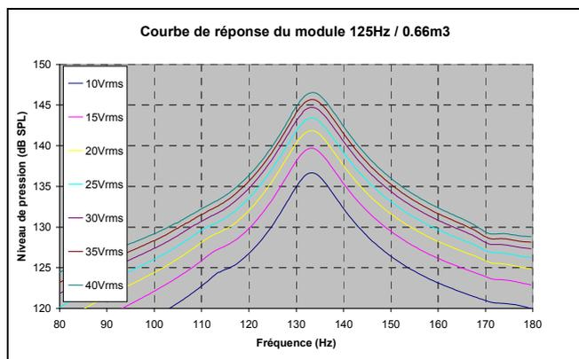
Figure 10 : courbe de réponse de l'actuateur 125Hz chargé par un volume clos de 0.66m<sup>3</sup>
