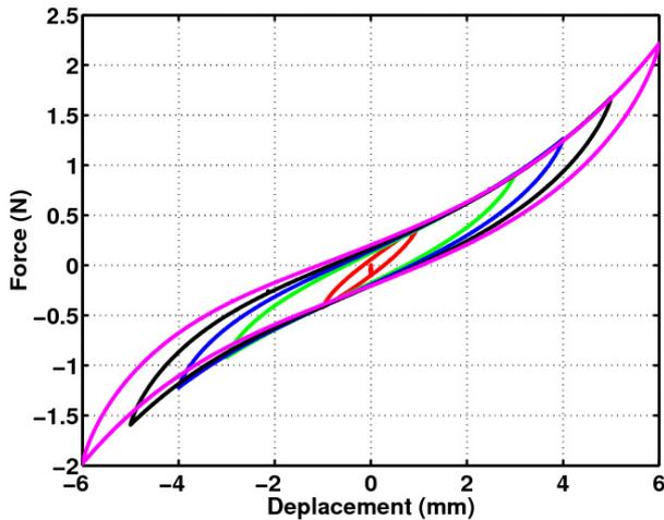
Figure 5 : essai de traction sur un petit boomer
