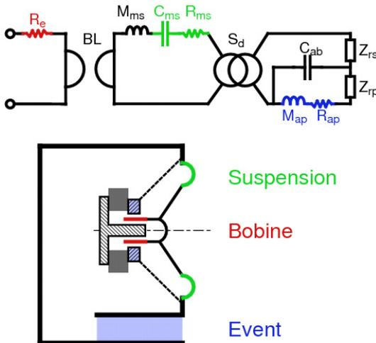
Figure 3 : schéma électroacoustique des actuateurs BF
