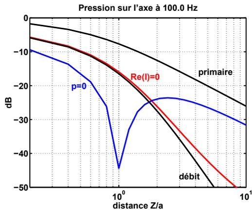
FIG. 5: Contrôle d'une source primaire de rayon  $a$  par une source secondaire concentrique. Noir : champ primaire, et contrôle annulant le débit total. Bleu : minimisation de pression en un point. Rouge : minimisation de la composante propagative.
