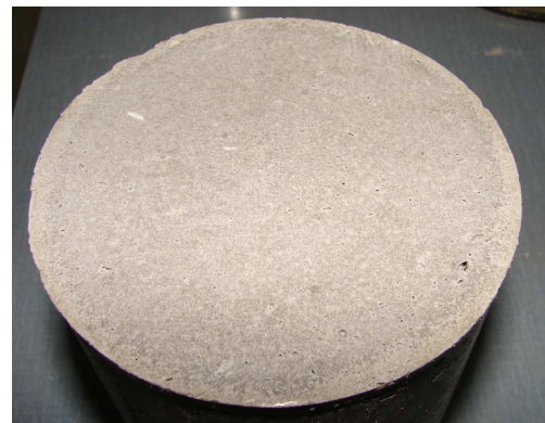
FIGURE 2 – Exemple d'un échantillon de liant à base de chaux aérienne - Diamètre 10 cm
