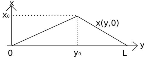
FIG. 8: Déformée initiale d'une corde pincée parfaitement flexible
