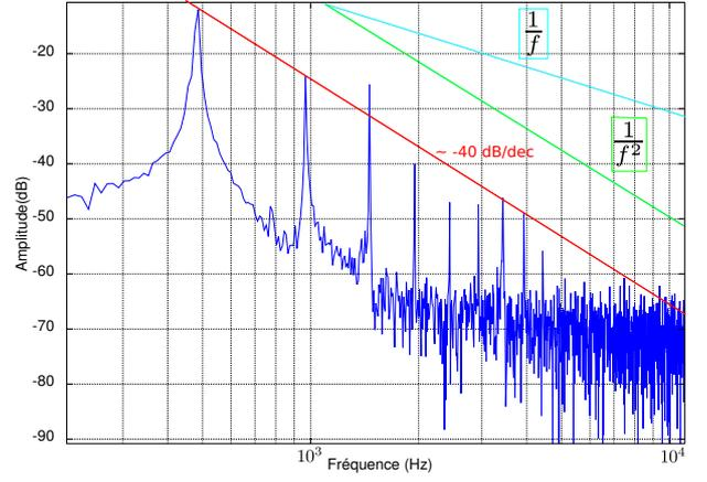
FIG. 7: Spectre d'un extrait du signal vibratoire de la table d'harmonie
