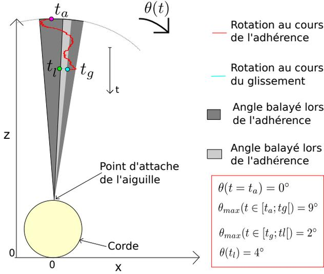
FIG. 5: Torsion de la corde lors du pincement
