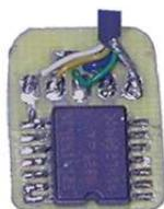
FIGURE 1 – Capteur MEMS (7 x 10 mm).
