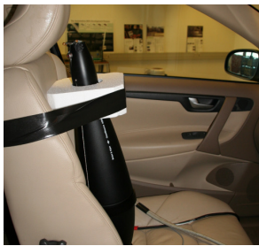
Figure 6 : Source de débit volumique sur le siège passager avant. L'orifice au sommet est montré ici dans le cas bloqué avec une plaque rigide sur laquelle est monté un microphone pour la mesure de la pression à la position d'écoute.
