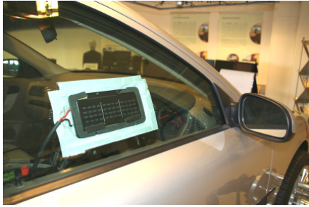
Figure 7 : un haut-parleur plat monté sur la fenêtre avant droit de la cabine.
