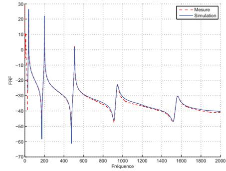
FIGURE 10 – Validation : simulation et mesure de la poutre bicouche (aluminium+M1)
