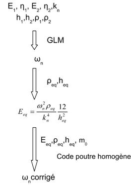
FIGURE 7 – Procédure de correction de la masse
