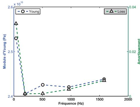
FIGURE 5 – Propriétés équivalentes de la poutre de base
