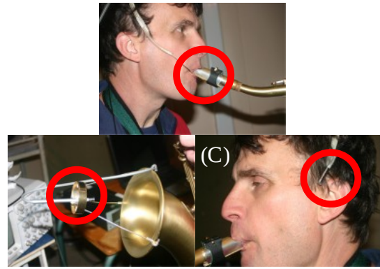
Figure 2: Vue des capteurs. (A) cathéter connecté au capteur de pression statique., (B) microphone près du pavillon, (C) microphone près de l'oreille.
