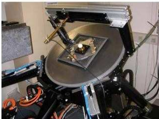
Figure 9 : Photo du laminographe disponible sur ID19, développé par une équipe du synchrotron allemand ANKA.
