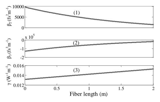
Fig. 6(a). Variation of GVD parameter (subplot-1), TOD coefficient (subplot-2) and nonlinearity parameter (subplot-3) along the proposed tapered CBLF length.
