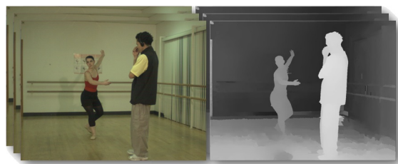
FIGURE 1 – Les données de type MVD comportent des séquences de texture (à gauche) et de profondeur (à droite)
