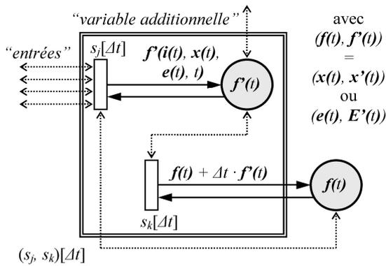
Figure 7. Méta-transition pour les réseaux de Petri
